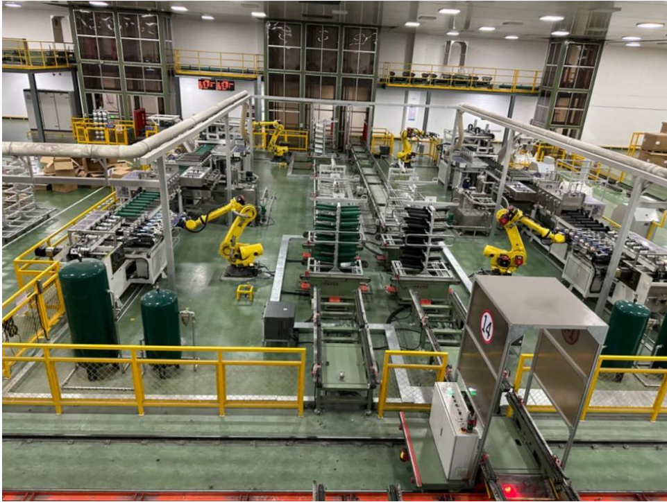
图注 18：面向电子级玻璃纤维及织物的智能物流系统
