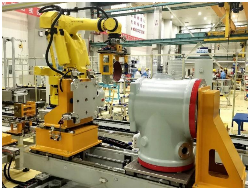
图注 13：平高集团平芝公司 126 千伏隔离开关智能化生产线现场
