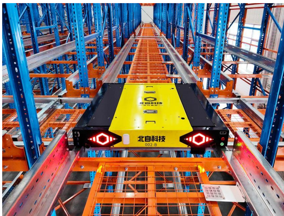
图注 5：新一代智能物流搬运系统四向穿梭车
